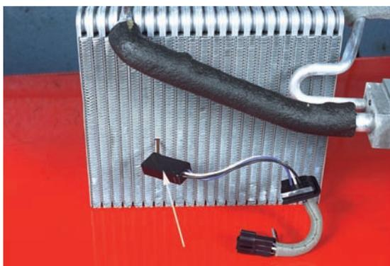
**Figure 1-20** Manoccontact thermostatique fixé sur un évaporateur.
