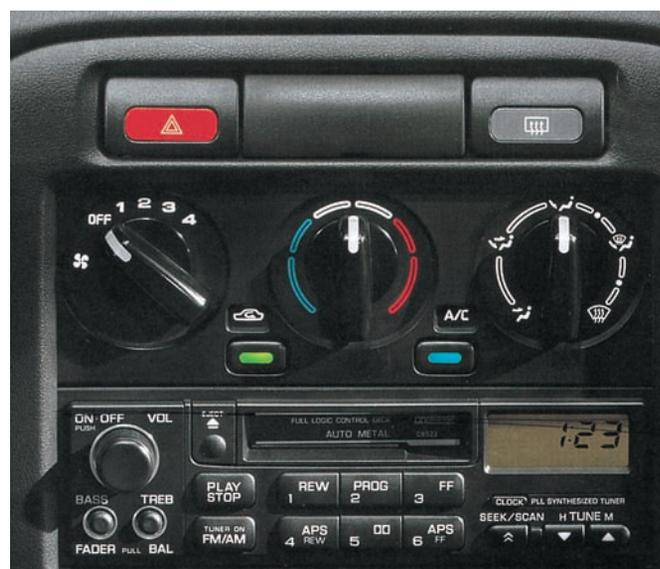
**Figure 1-21** Tableau de commande de climatisation type Nissan
