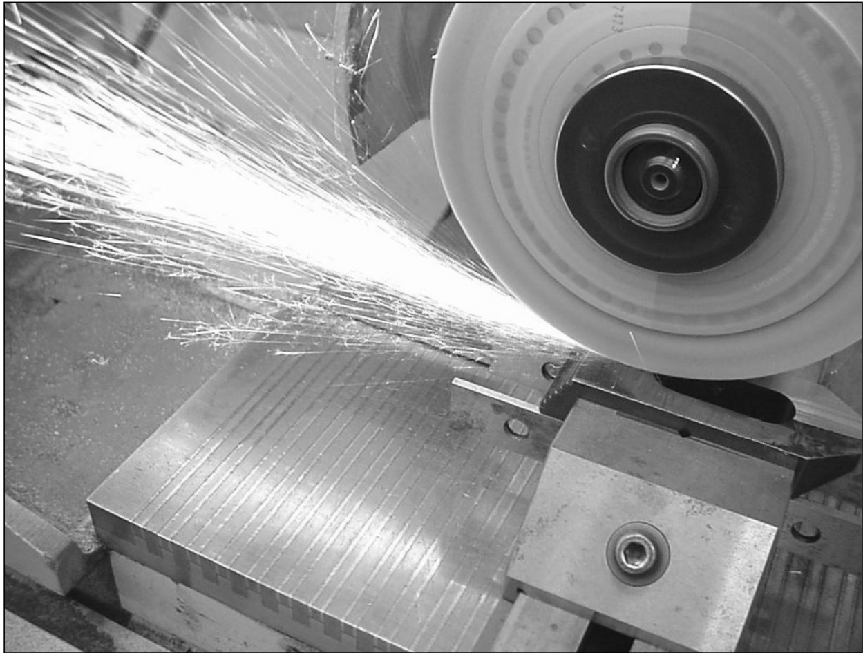
FIGURE 14-3 La clé des passes profondes en rectification : une alimentation transversale minimale.
