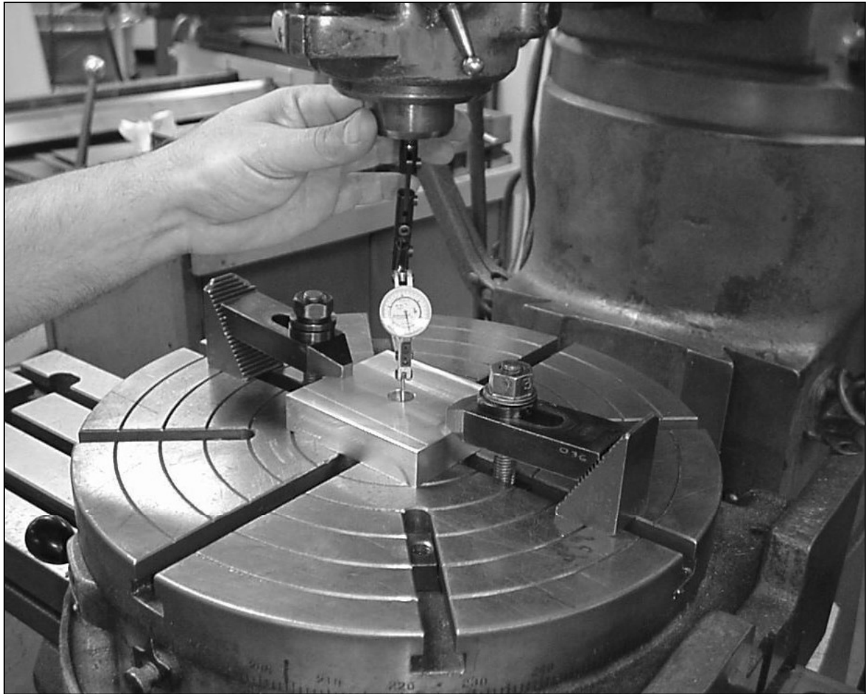
FIGURE 10-2 Alignement de l'axe de la machine avec celui de la pièce au moyen de mouvements de la table en X et en Y.
