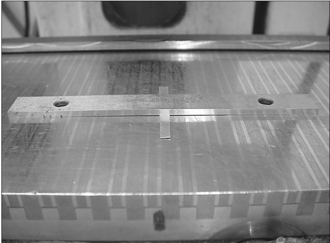
FIGURE 11-1 Un feillard comble l'espace se dessinant sous la courbure d'une pièce gauchie déposée sur la table d'une rectifieuse afin que la pièce ne s'aplatisse pas complètement sur la table sous l'effet de la force magnétique du plateau. Il sera possible ainsi de rectifier la pièce et de la redresser.
