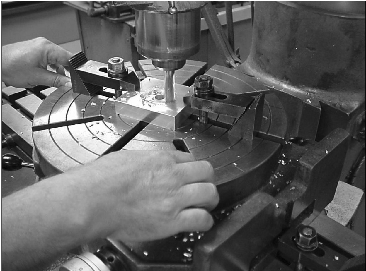
FIGURE 10-4 La table rotative permet d'usiner facilement les lamages de grande dimension.
