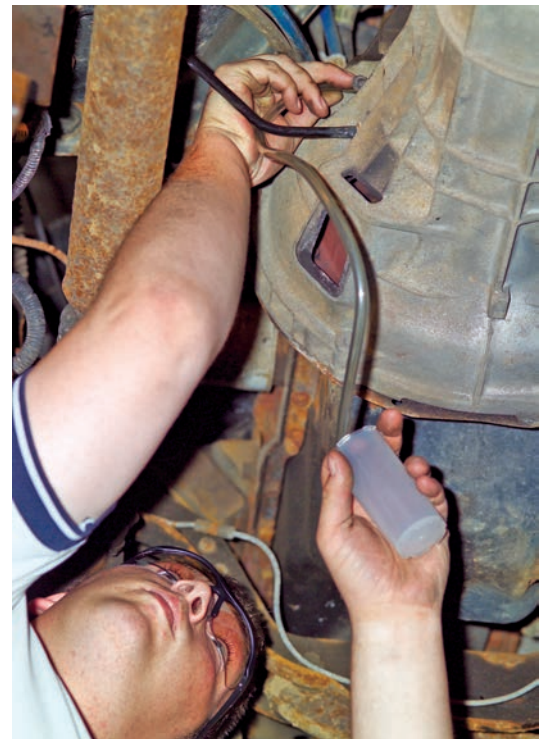
Figure 1-30 Avant de purger le système, reliez un tuyau flexible entre la vis de purge et un contenant.
