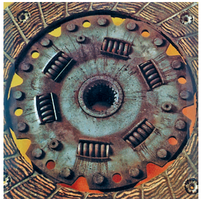
Figure 1-20 La présence de graisse et d'huile sur le moyeu de ce disque indique que le disque peut être contaminé par de l'huile. Luk Automotive Systems
