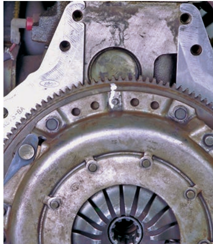
P1-2 Avant de démonter l'embrayage, assurez-vous que des marques d'alignement sont présentes sur le plateau de pression et le volant moteur.
