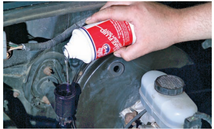
Figure 1-29 Remplissez le réservoir d'un fluide adéquat.
