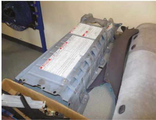
**2** Après avoir vérifié que la tension résiduelle est bien dissipée, retirez le siège arrière et le couvercle de la batterie HT. Suivez toujours les consignes de sécurité spécifiées par le constructeur du véhicule.
