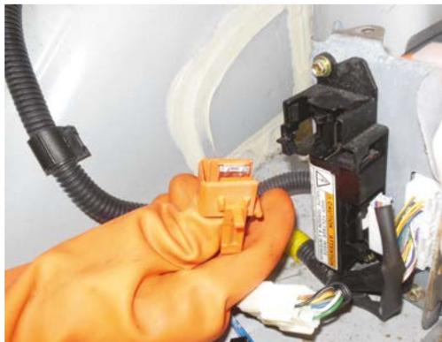
**1** Pour désactiver le système haute tension, coupez le contact, débranchez le câble négatif de la batterie auxiliaire 12 V, puis retirez la fiche de sécurité de la batterie haute tension.
