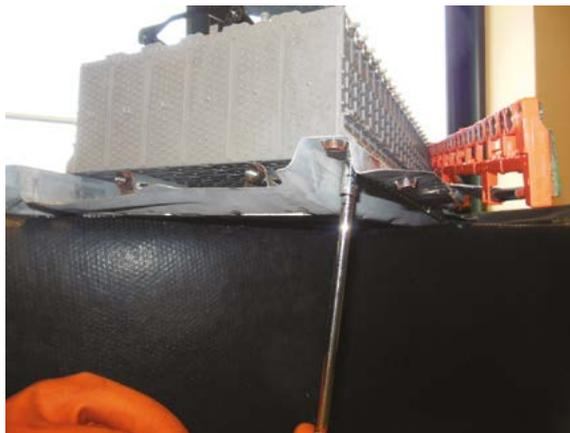
**10** Retirez les boulons de fixation des modules sur la base du bloc-batterie.
