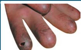
**5** L'usure de ce gant se détecte par une simple inspection visuelle. Notez que le matériau du gant en caoutchouc peut être endommagé par les produits pétroliers, les détergents, certains savons pour les mains et même le talc.
