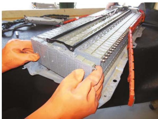
**11** Retirez le premier module à l'extrémité de la batterie pour la mesurer avec un voltmètre.
