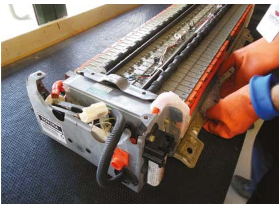
**5** Placez la batterie HT sur un établi en bois ou recouvert d'un épais tapis isolant en caoutchouc.
