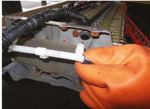
**8** Retirez les tubes de mise à l'air libre de la batterie haute tension.
