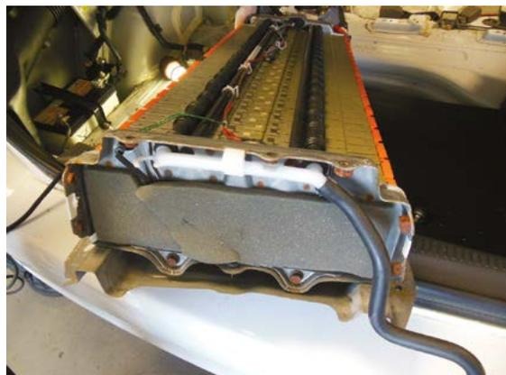
**4** Retirez la batterie HT par l'arrière du véhicule.
