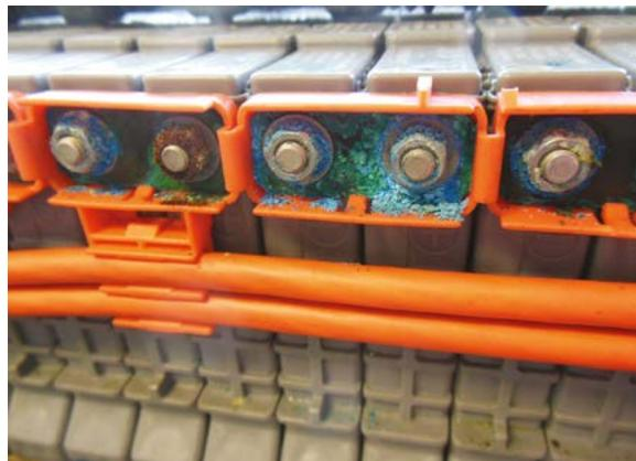
**6** Une inspection visuelle montre de la corrosion sur de nombreuses connexions électriques à l'extrémité des modules.
