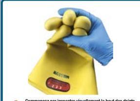
**4** Commencez par inspecter visuellement le bout des doigts du gant, en vous assurant qu'il n'y a pas de coupures ou d'autres dommages.
