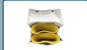
**12** Les gants en caoutchouc ne doivent pas être pliés quand on les insère dans le sac en toile. La pliure augmente la contrainte mécanique sur le caoutchouc et peut entraîner une défaillance prématurée du matériau du gant.
