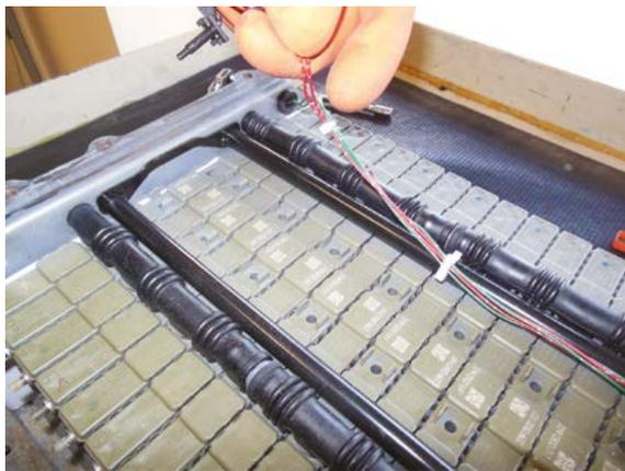
**7** Retirez les capteurs de température du bloc-batterie haute tension.
