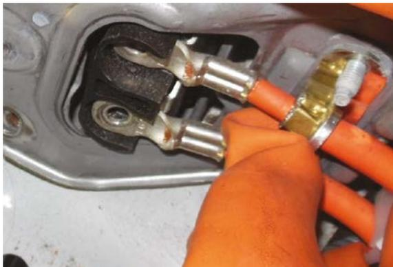
**3** Retirez les fils haute tension de la batterie en portant l'ensemble de gants isolants.
