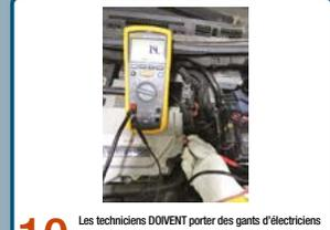
**10** Les techniciens DOIVENT porter des gants d'électriciens lorsqu'ils travaillent à proximité des zones HT d'un véhicule hybride ou électrique.
