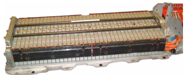
FIGURE 10-8 Une Toyota Camry hybride est équipée d'une batterie NiMH haute tension de 244 volts, composée de 204 cellules organisées en 34 modules, chacun délivrant 7,2 volts.
