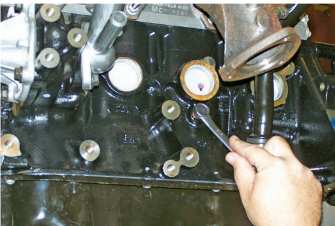
Figure 1-52 La plupart des moteurs ont des bouchons de drainage permettant de vidanger le liquide de refroidissement du bloc-cylindres.
