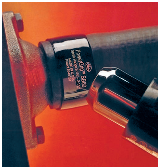
Figure 1-47 Le serrage des colliers de thermo-plastique s'effectue avec un pistolet chauffant. Gates
