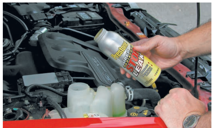
Figure 1-54 Addition d'un antifuite dans le système de refroidissement. Honeywell
