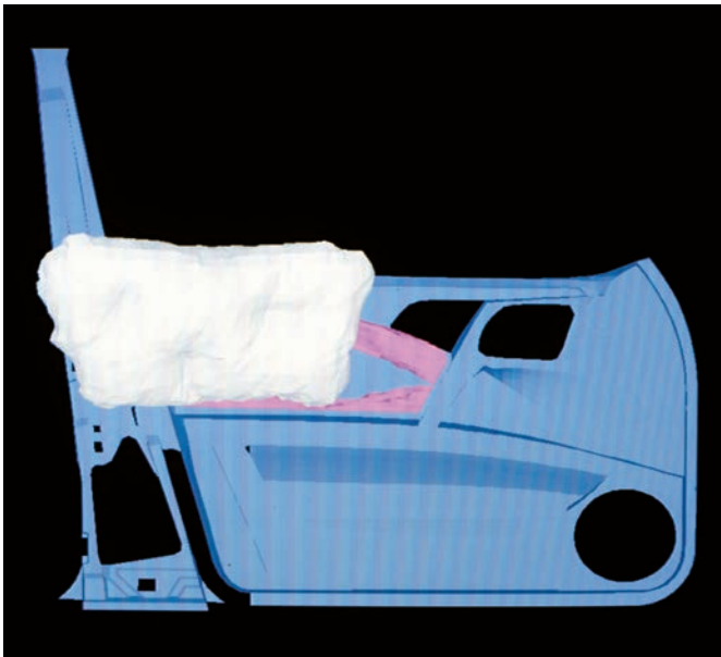
Figure 1-16 Coussin gonflable latéral dissimulé dans une portière. Chrysler LLC
