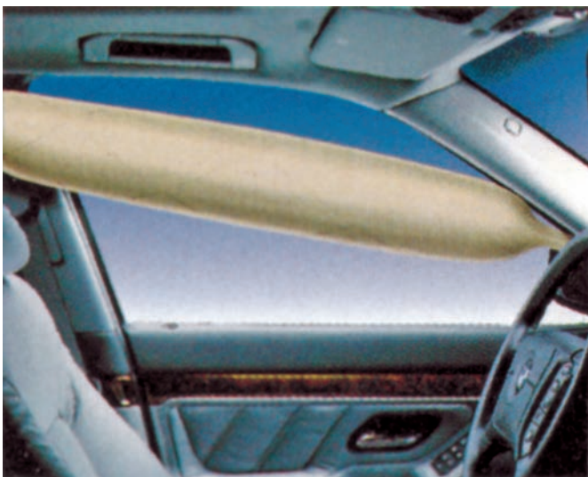
Figure 1-17 Coussin gonflable latéral conçu pour protéger la tête de l'occupant. BMW
