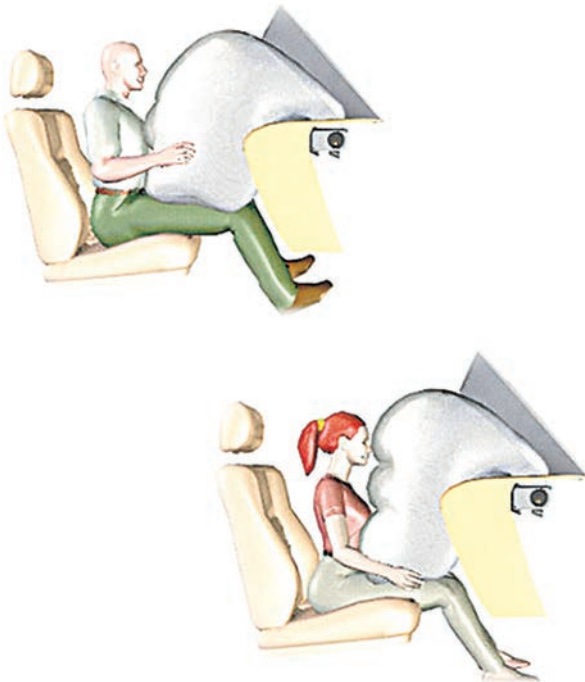
Figure 1-19 En haut, déploiement à pleine force du coussin gonflable en fonction du poids de l'occupant. En bas, déploiement à force réduite du coussin gonflable en fonction du poids de l'occupant. Delphi
