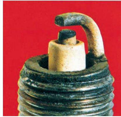
Figure 2-51 Usure normale d'une bougie d'allumage. Federal Mogul
