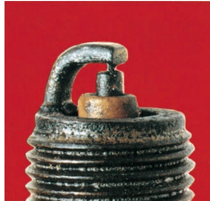
Figure 2-56 Pont de carbone entre les électrodes d'une bougie d'allumage. Federal Mogul
