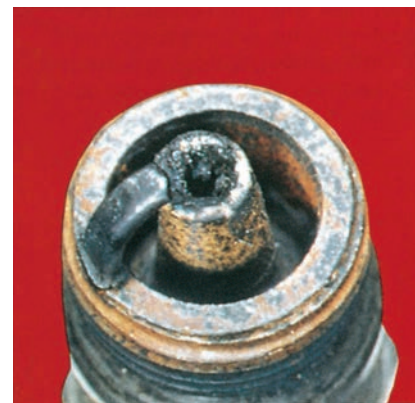
Figure 2-58 Bougie d'allumage endommagée par préallumage. Federal Mogul
