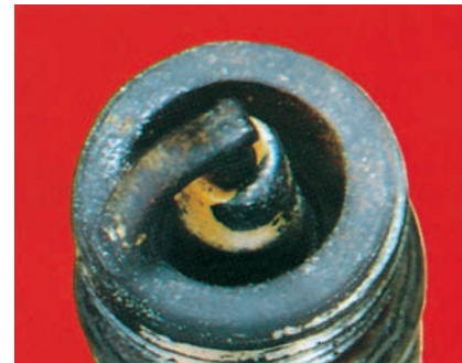
Figure 2-55 Bougie d'allumage encrassée par projection. Federal Mogul
