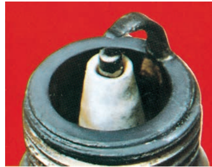
Figure 2-57 Bougie d'allumage qui a surchauffé. Federal Mogul
