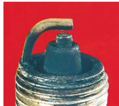
Figure 2-53 Bougie d'allumage encrassée à froid. Federal Mogul
