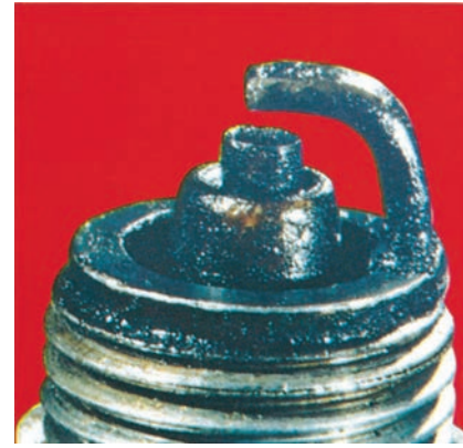
Figure 2-54 Bougie d'allumage encrassée d'huile. Federal Mogul
