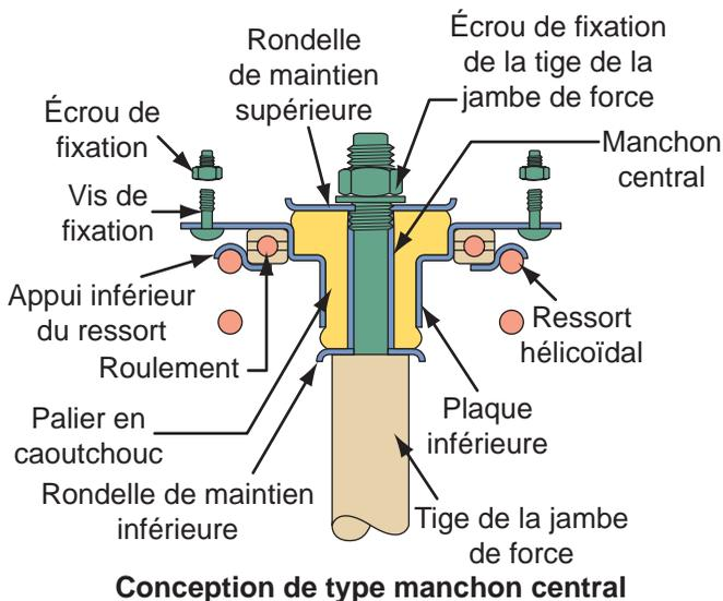
**Figure 2-19** Les différents types de fixation de l'extrémité supérieure d'une jambe de force.
