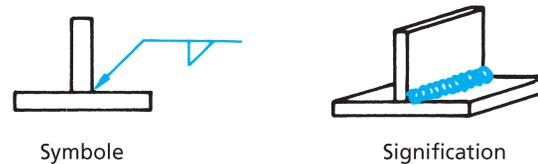
FIGURE 12.8 ■ Soudure d'angle continue.
