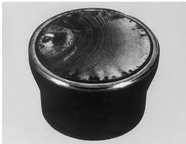
Figure 6-33 Légères fissures dans le métal conduisant à la rupture complète du croisillon. Arvin Meritor
