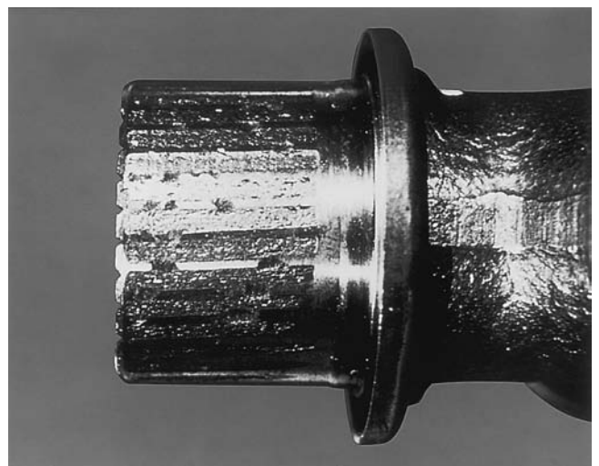
Figure 6-31 Exemple d'effritement ou d'écaillage sur la surface d'un tourillon d'un joint universel. Arvin Meritor
