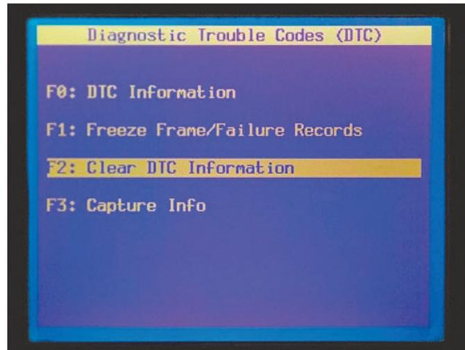
**Figure 1-33** Récupérez et notez les codes d'anomalies et les enregistrements de données, puis effacez ces informations et effectuez un essai sur route du véhicule pour vous assurer qu'aucun nouveau code ne s'inscrit dans la mémoire de l'ordinateur.
