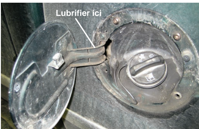
Figure 2-6 Lubrification du volet d'accès au réservoir d'essence.
