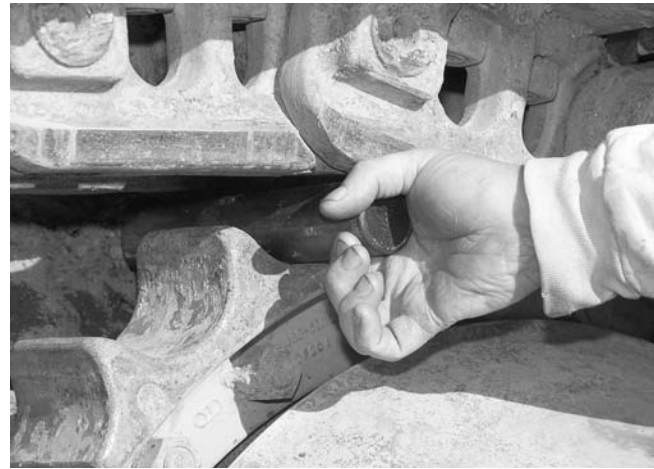
Figure 2-27 Comment tendre la chenille pour évaluer l'usure des axes et des bagues. Caterpillar
