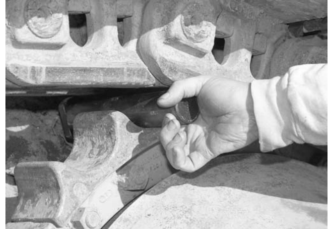
Figure 2-34 Un technicien insérant un axe de chenille entre les dents du barbotin. Caterpillar
