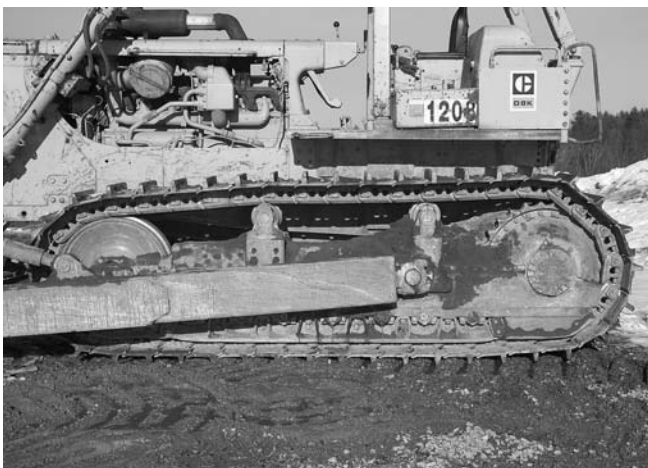
Figure 2-24 Chenille trop tendue (ajustée trop serrée). Caterpillar
