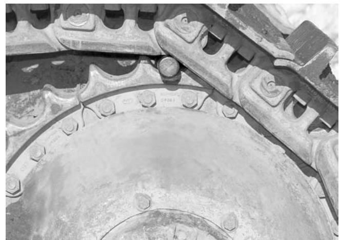
Figure 2-35 Axe bien positionné (12 heures). Caterpillar
